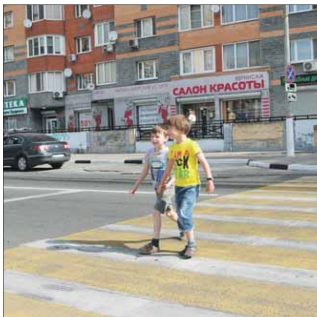
Термопластик посыпают микроскопическими стеклянными шариками
