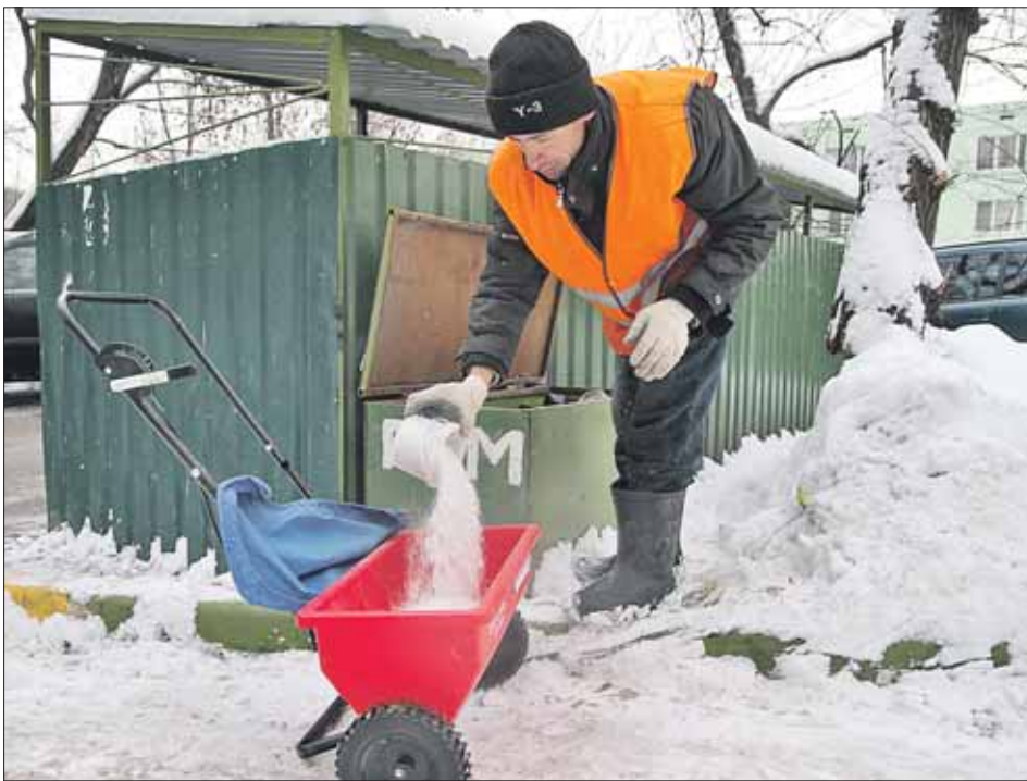
Вот из такой тележки с дозатором дворники должны рассыпать реагенты
