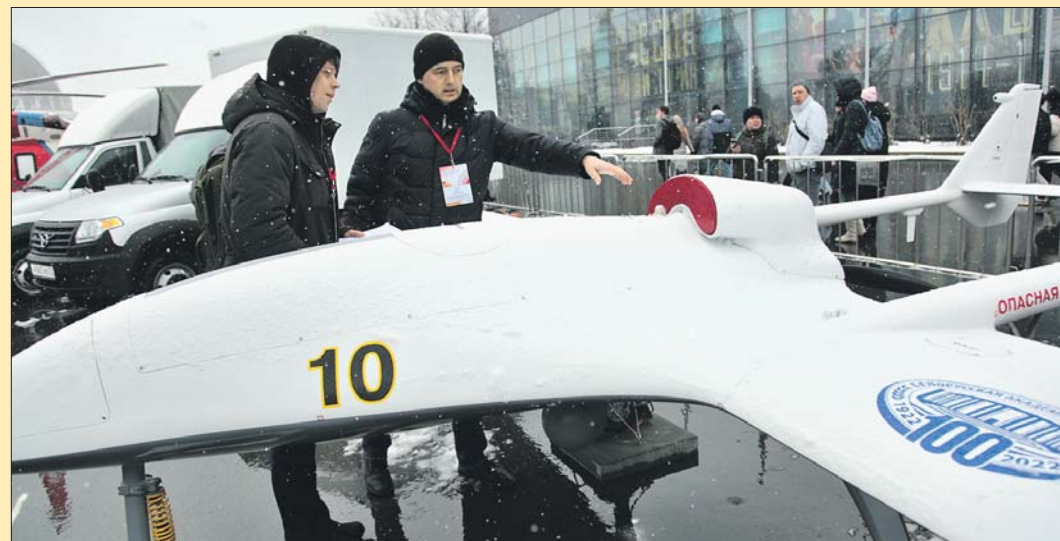
Минские инженеры создали беспилотный самолёт «Буревестник». Он может использоваться для оценки ситуации при паводках и лесных пожарах. «Буревестник» без дозаправки способен покрыть расстояние до 900 километров
