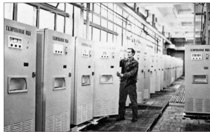
Наладка автоматов для продажи газированной воды на Перовском заводе торгового машиностроения. Москва, 1980 год
